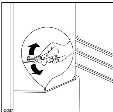
На внутренних поверхностях морозильного отделения образуется, через некоторое время, слой льда. Когда толщина этого слоя превышает 4 мм, лед необходимо удалять с помощью пластмассового скребка, поставляемого в комплекте с прибором.
