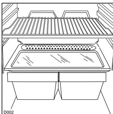
Стеклянная полка над ящиком для овощей имеет специальный фильтр "СВЕЖЕСТЬ", который обеспечивает необходимую вентиляцию и значительно сокращает высыхание
